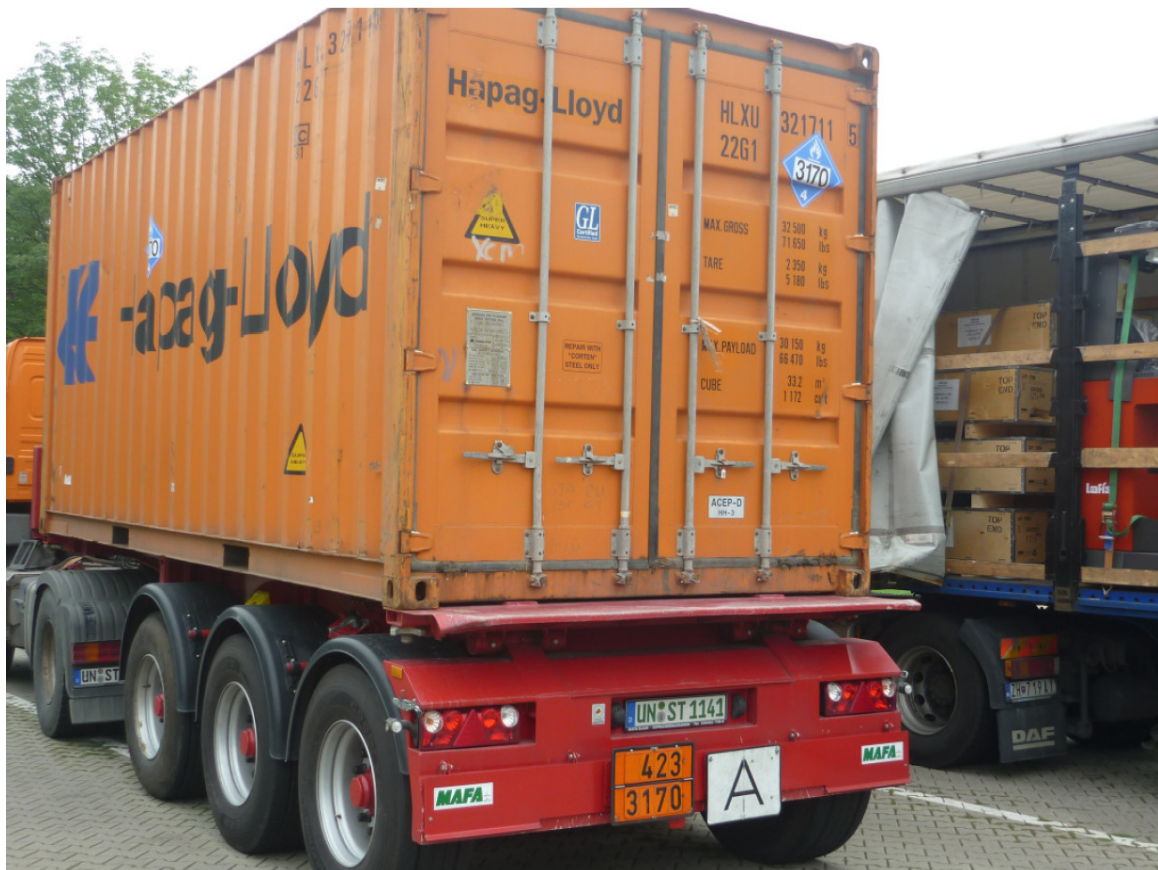
Abbildung 2: Kennzeichnung des Containers nach ADR
